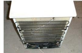
Wird es im Kühlschrank zu warm, verdunstet das flüssige Kühlmittel im Rohrsystem. Die notwendige Energie für das Verdunsten wird dem Kühlgut entzogen.
