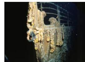
Experimente zeigten, dass ‚sulfatreduzierende Bakterien‘ (SRB) bei der Bildung von Rost sowie  $\text{FeS}$  beteiligt sind.
