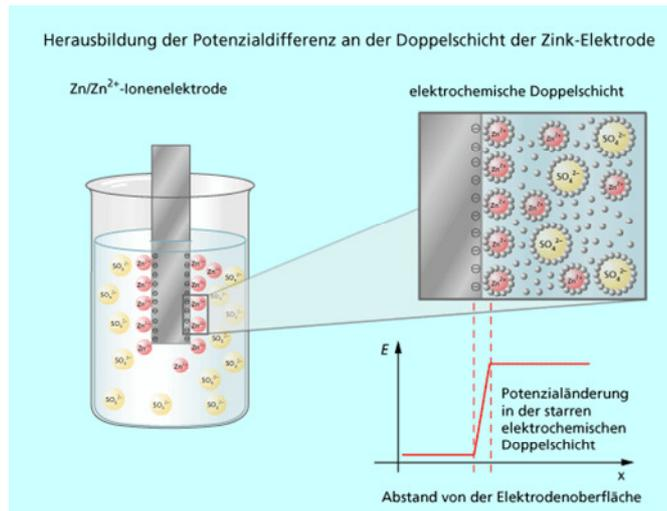
Die Teilchen  $\odot$  symbolisieren Wassermoleküle, die die Hydrathülle der Ionen bilden.  $\ominus$  sind Elektronen in der metallischen Phase. Zwischen Elektrolytlösung und metallischer Phase stellt sich ein elektrochemisches Gleichgewicht ein.
