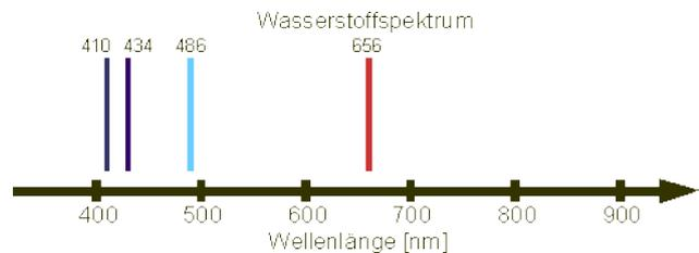
Abbildung 31 Spektrallinien des Wasserstoffatoms
