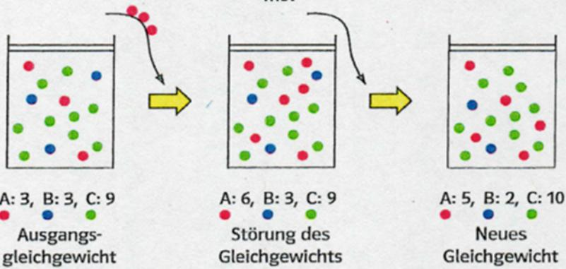
Zufuhr eines Reaktionspartners (hier: A) verschiebt das Gleichgewicht in die Richtung, die einen Teil dieser Komponente verbraucht.
