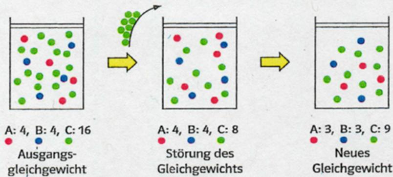
Wegnahme eines Reaktionspartners (hier: C) verschiebt das Gleichgewicht in die Richtung, die einen Teil dieser Komponente entstehen lässt.
