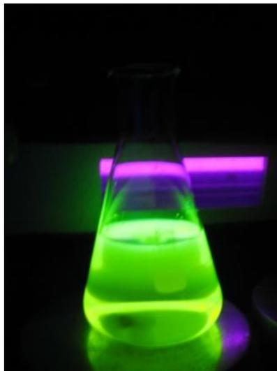
Abbildung 3-19: Beim Zugabe von Natronlauge erhöht sich Löslichkeit in Wasser und unter UV-Licht ist eine gelbgrüne Fluoreszenz feststellbar.
