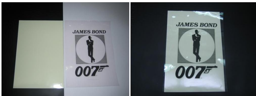
Abbildung 3-40: Die transparente OHP-Folie wird auf die Leuchtfolie gelegt und mit dem Licht einer Taschenlampe bestrahlt.
