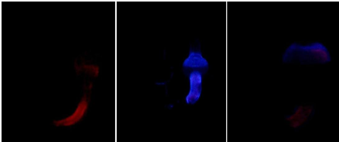
Abbildung 3-47: Reines rotes Singulett-Sauerstoffleuchten (links), verstärktes blaues Luminolleuchten bei zu großer Menge an Luminol (Mitte) und rotes Singulett-Sauerstoffleuchten innerhalb des blauen Luminolleuchtens (rechts).
