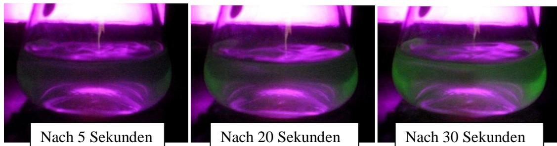
Abbildung 3-10: Fluoreszenzrückkehr nach dem Verschwinden der Fluoreszenz durch Natriumdithionit-Lösung.
