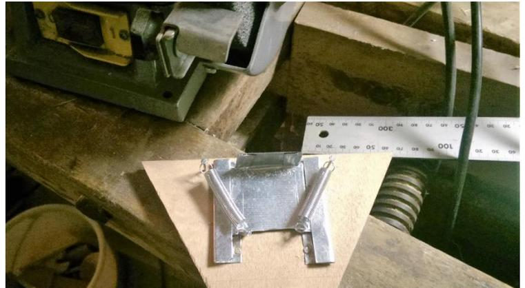
Abb. 16: Öffnungsmechanismus, links daneben Schleifmaschine
