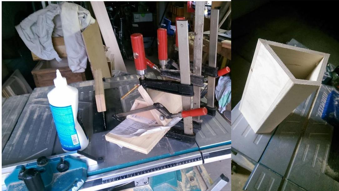
Abb. 15: Verleimen eines Inhaltsbehälters, links neben ihm das Blatt der Kreissäge, rechts daneben ein fertiger Behälter
