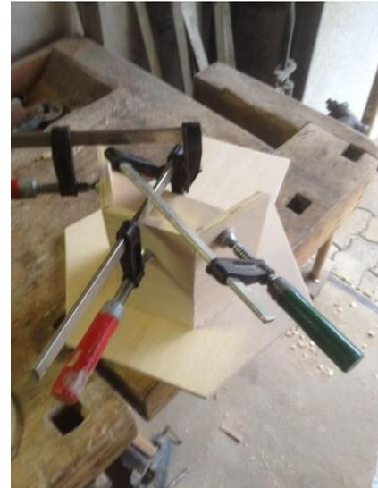
Abb. 20: Verleimen der Grundplatte mit dem Sockel
