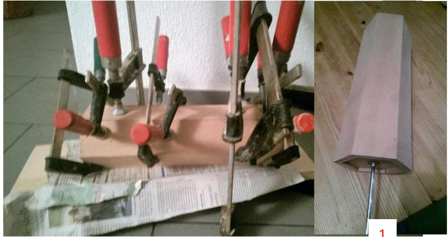
Abb. 17: Turm beim Leimen, rechts fertiger Turm
