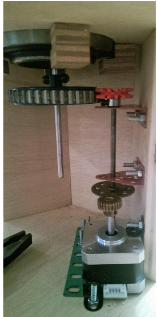
Abb. 22: Getriebe für den grossen Stepper
