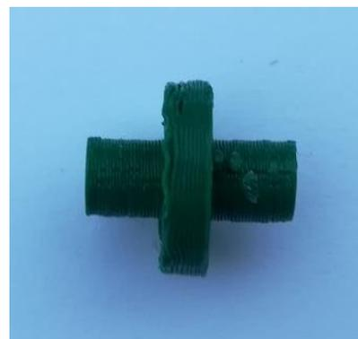
Abbildung 43: kurze Bindung Original und 3D-Druck mit respektive ohne Stützen
