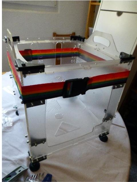
Abbildung 16: Gehäuse mit Kofferband
