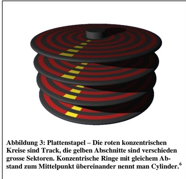
**Abbildung 3: Plattenstapel – Die roten konzentrischen Kreise sind Track, die gelben Abschnitte sind verschieden grosse Sektoren. Konzentrische Ringe mit gleichem Abstand zum Mittelpunkt übereinander nennt man Cylinder.<sup>6</sup>**
