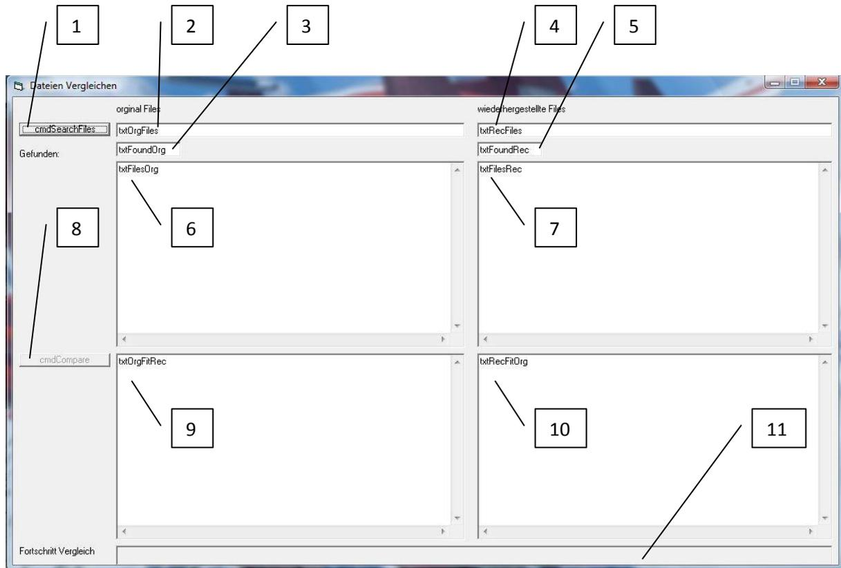
Abbildung 18 Das Programmfenster mit den Namen der Steuerelemente<sup>36</sup>
