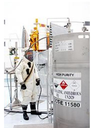
Arbeit im Vollschutzanzug bei der Betankung der Raumsonde MESSENGER mit Hydrazin
